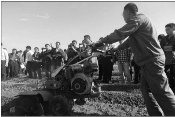
华星农业机械研发的自动载苗机正在运作。
