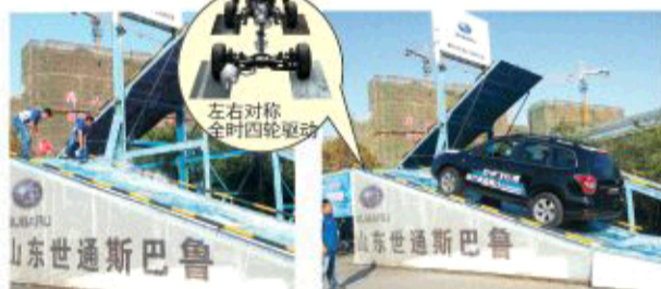
仿冰雪路面的坡度是17度,坡长10米 斯巴鲁四轮驱动可以在冰雪坡道上轻松起步
