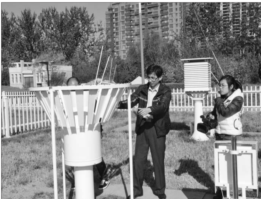
11月3日,在德州市长河公园观测站内,新安装的称重式降水观测器已经启用。本报记者 孙婷婷 通讯员 郭宝阳 摄影报道
