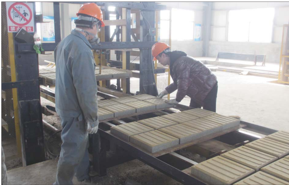
建筑垃圾资源化生产流水线。本报记者 臧振 摄
