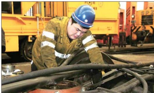
1月4日,济南工务机械段开始对机械设备进行冬季集中检修,确保以良好的设备状态投入到今年的施工中。他们将对98台机械设备进行分阶段、分批次的冬季集中检修。目前,第一批66台机械设备已在紧张的检修中。图为检修人员正在对转向架进行认真检查。 边鹏 摄
