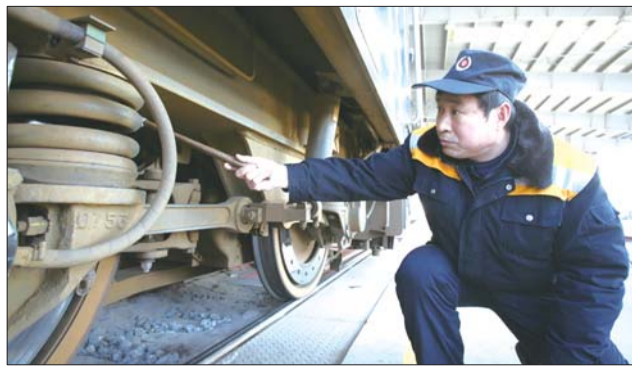
高洪金在出乘前检查机车走行部。
