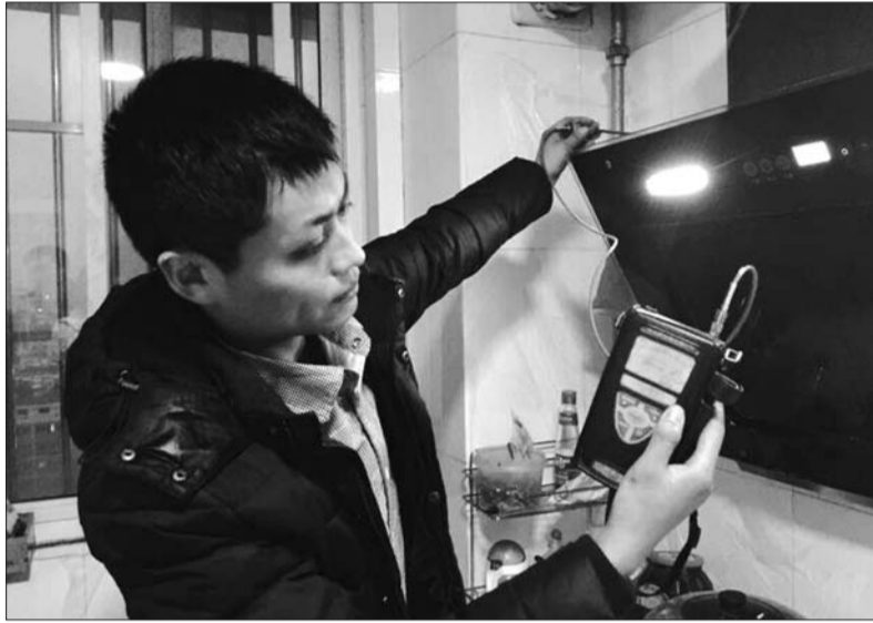
燃气公司工作人员检查,燃气检测仪显示没有燃气泄漏的情况。本报记者 康宇 摄
