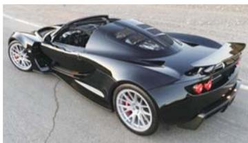
▲这款Hennessey Venom GT搭载一台7.0L V8双涡轮增压发动机, 最大功率达到惊人的1244马力, 最大扭矩1566N·m, 并匹配6速手动变速箱。
