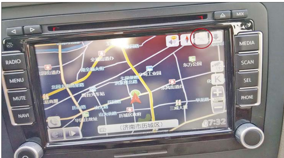
无论孟女士的车行驶到哪里，导航仪的地图和箭头都没有变化，红圈处卫星信号无显示。
