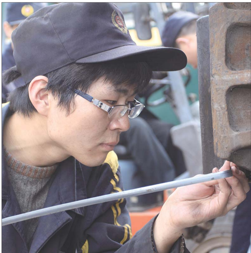
济南车辆段职工在检测车体磨损情况。
