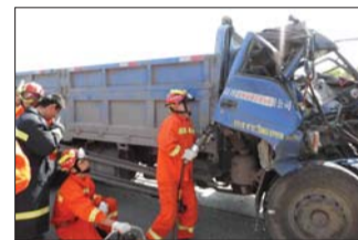
消防官兵利用救援器材扩张变形驾驶室。
