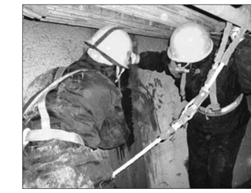
球罐内部超声波检验。
