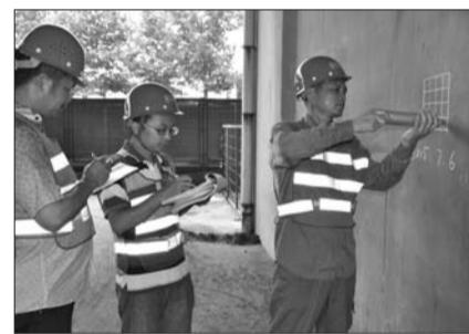
通过回弹仪检测桥墩强度。
