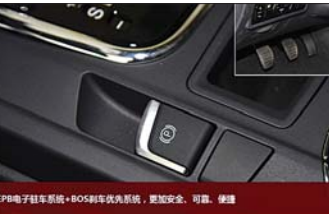
EPB电子驻车系统、BOS刹车优先系统,更加安全、可靠、便捷
