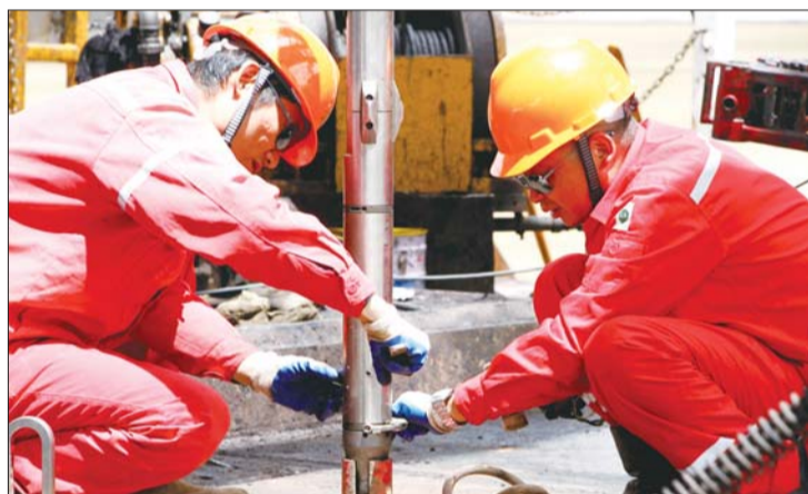
队员正将地震波采集仪器下入井中。
