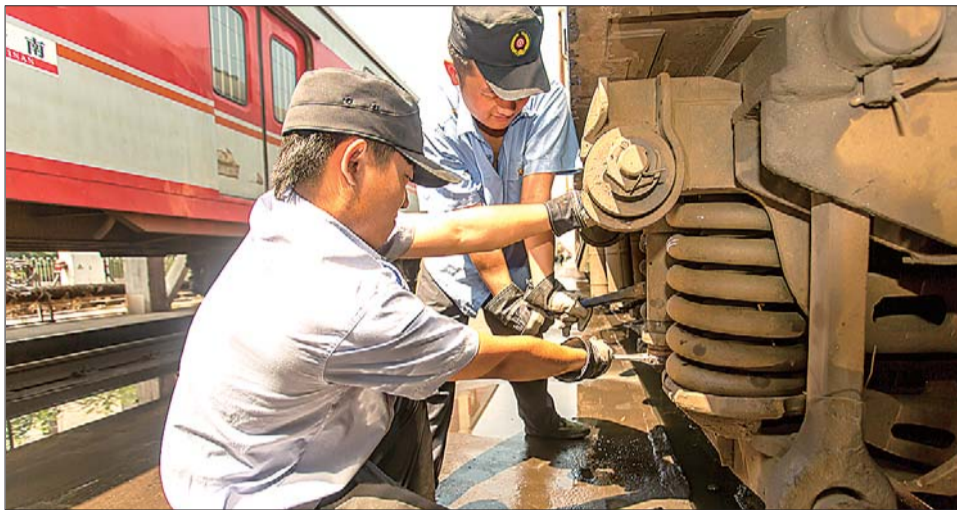
济南车辆段库检车间检车员排除列车油压减震器故障。
