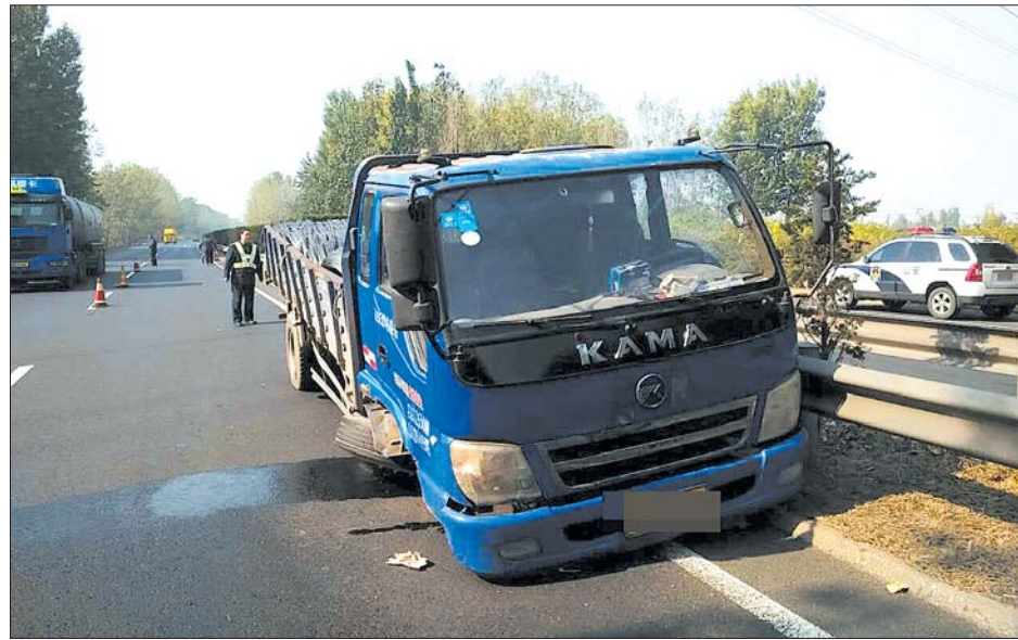
货车装载9吨钢筋,远超车身荷载吨数,在高速公路上前桥和两个车轮全部脱落,一头栽倒。
