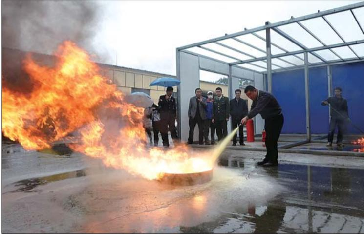
▲实验中,装滑石粉的灭火器无法将火扑灭。
