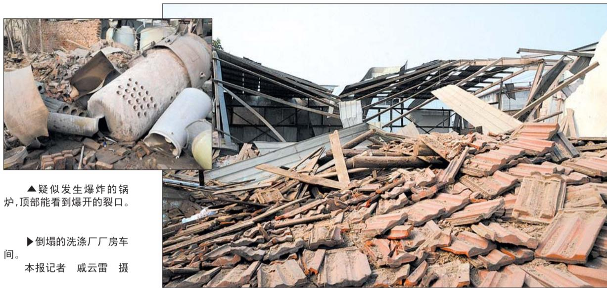
▲疑似发生爆炸的锅炉,顶部能看到爆开的裂口。
