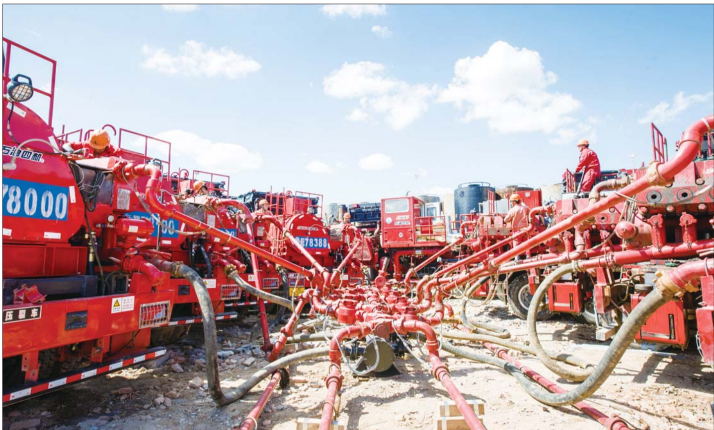
盐227井工厂大型压裂施工。
