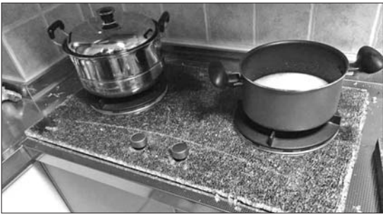
梁女士的钢化玻璃燃气灶炸后的情形(当事人提供)。
