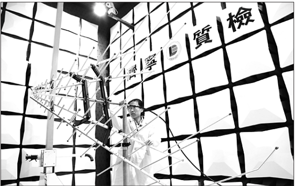
检验人员在调试EMC抗扰度测试系统。本报记者 黄广华 摄
