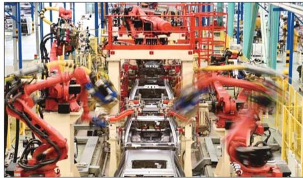
山东威海南海新区德瑞博新能源汽车生产车间的工业机器人在进行焊接作业。 据新华社
