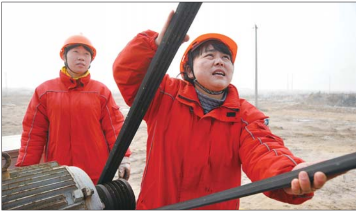
电机皮带松紧度要适中,不仅起到节电作用,还能延长皮带使用寿命。
