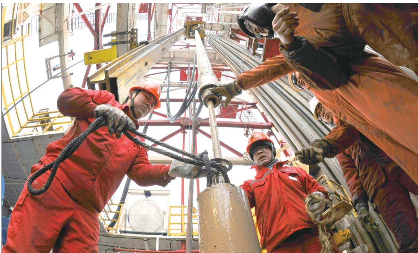
新胜利一号平台正在进行完井作业施工。 本报通讯员 王为 摄
