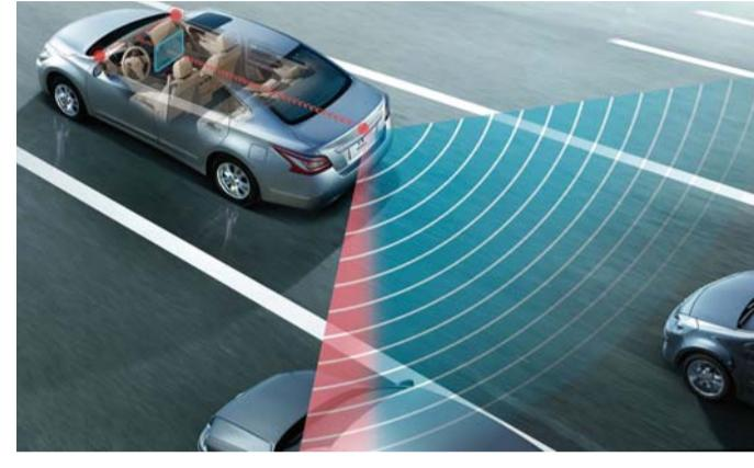
式整体安全系统,通过车辆四周的摄像头,实时监测车辆四周3米范围内状况,拥有车道偏离预警、变道盲区预警和移动物体/行人探测预警
