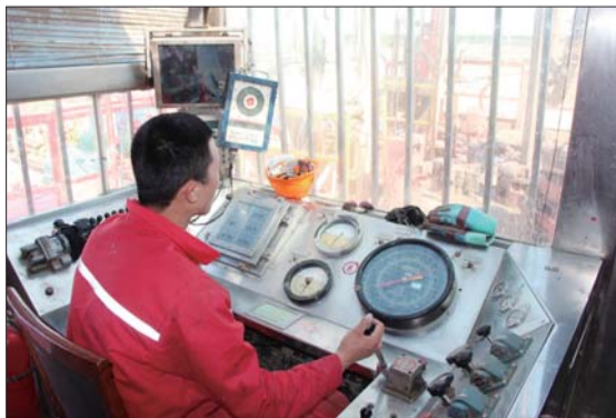
司钻操作室只有三四平方米,司钻就是在这里操纵滑动游车。
