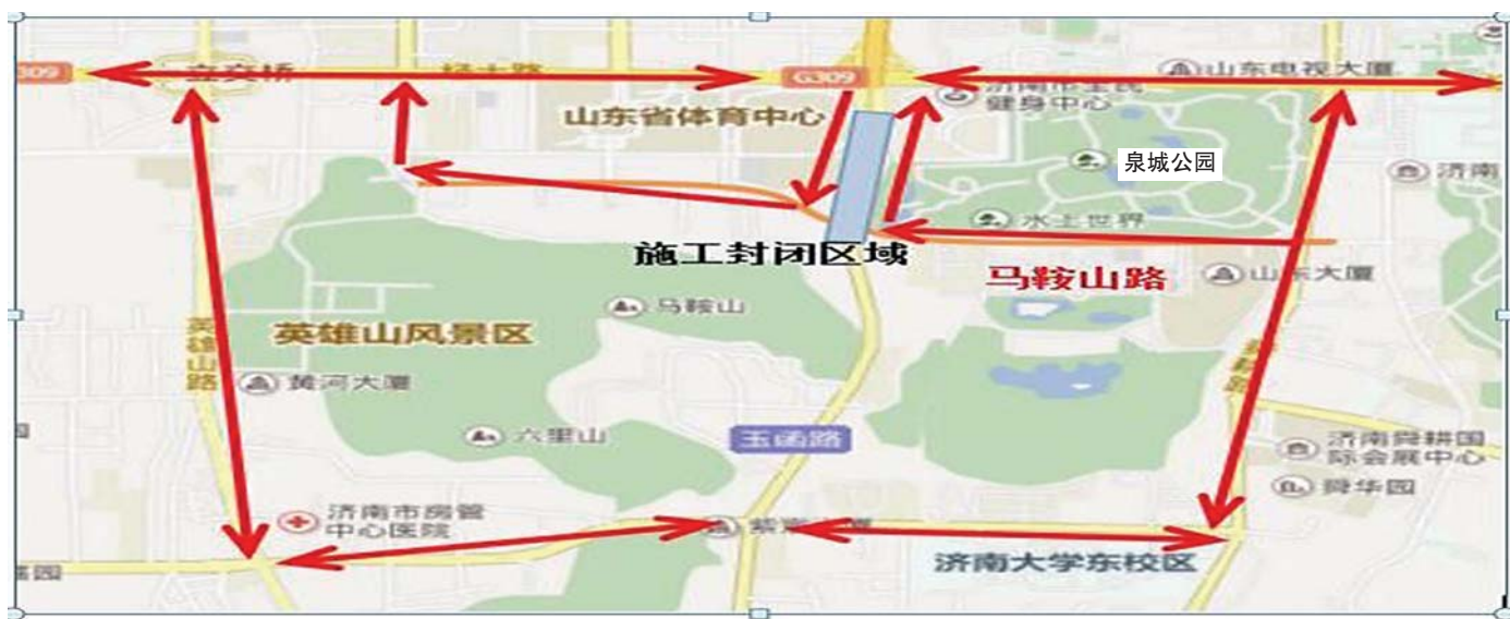
► 顺河高架南延施工绕行图。
