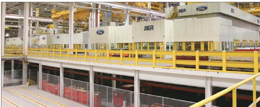
济南二机床为福特汽车提供的大型高速冲压生产线。(受访者供图)
