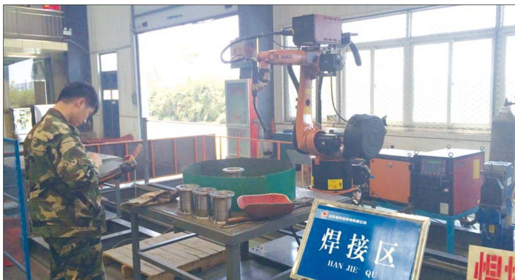
山东金科星机电有限公司生产的托绳轮靠机器人焊接。
