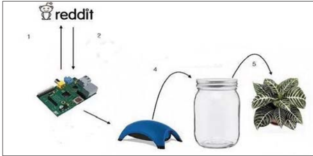
Tyler设计的可以让网友浇水的装置示意图
