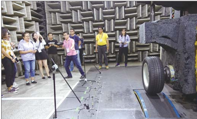
玲珑轮胎的噪声测试实验室,墙上挂满了吸音材料。
