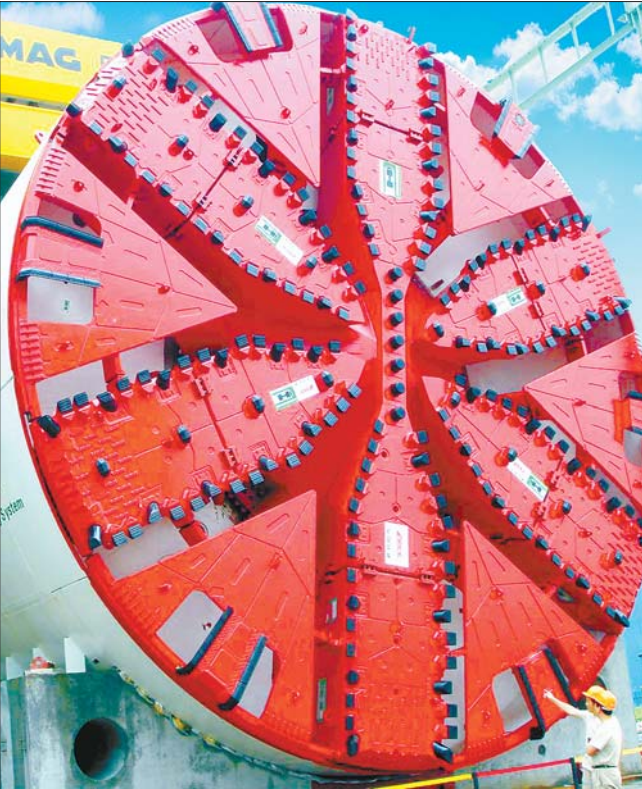
大直径盾构机进入施工现场。 通讯员 梁栋方 摄
