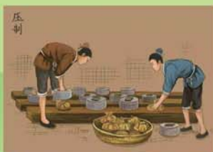
根据成品的要求把晒青的茶叶称足重量用蒸汽蒸透，放在不同模具里压成形。
