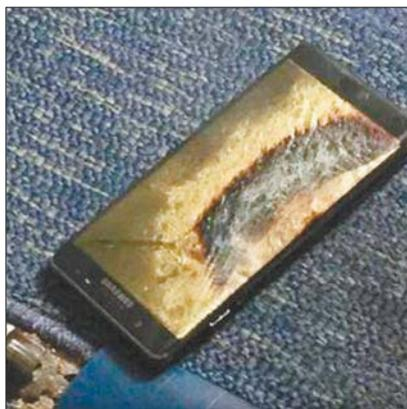
换新机后发生燃损事件的Note7手机。
