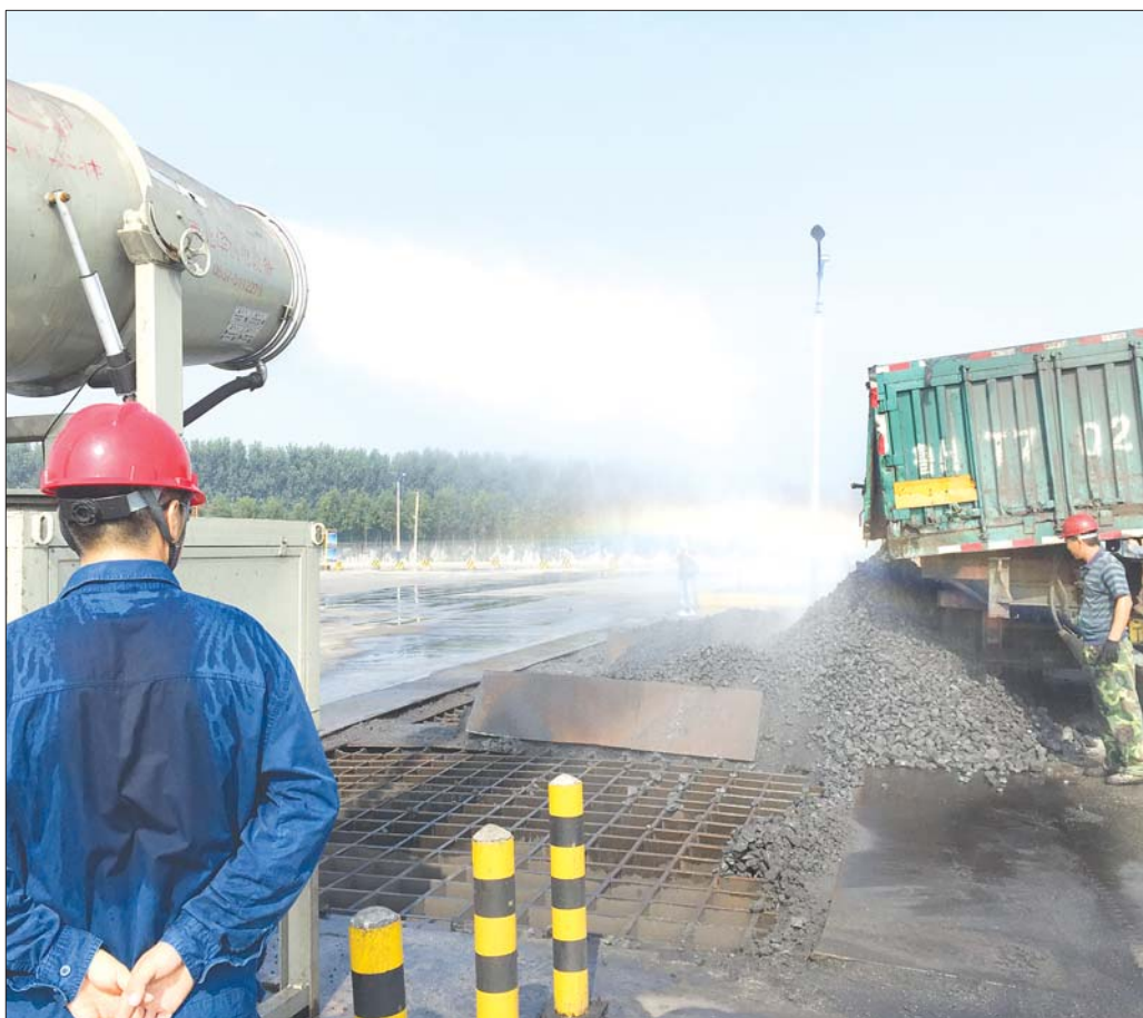
荣信港安装风送式喷雾机抑制扬尘(资料图)。
