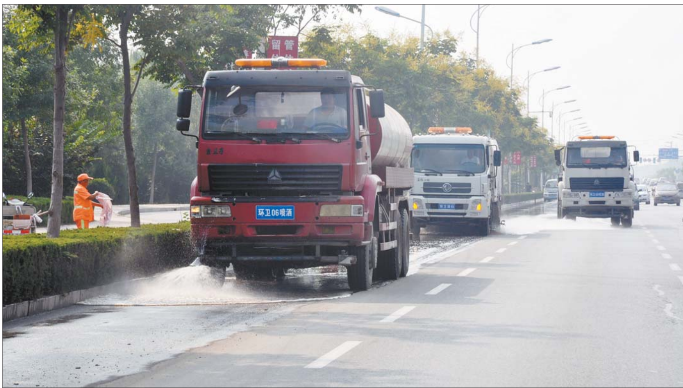
环卫中心冲刷车辆正在冲刷地面。
