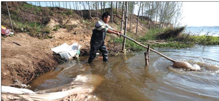
切穰后,把切片装布袋里,在河里用鼓凸杆撞击,使碎片分解成纤维,俗称撞穰。
