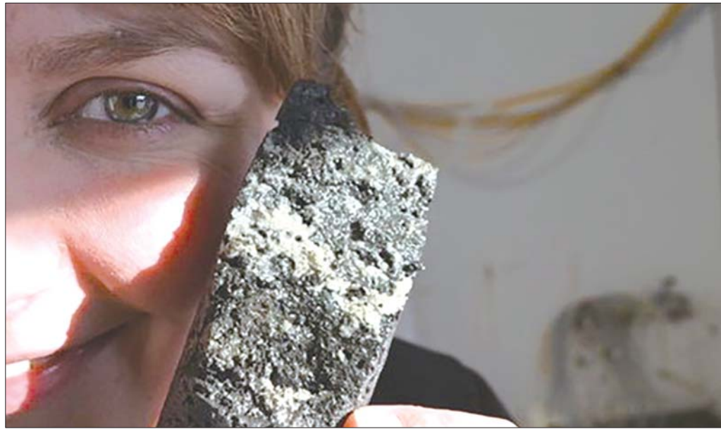
碳注入地下玄武岩层,转化为固态碳酸盐。科学家在冰岛试验的碳捕捉封存计划“碳固定”,把二氧化碳
