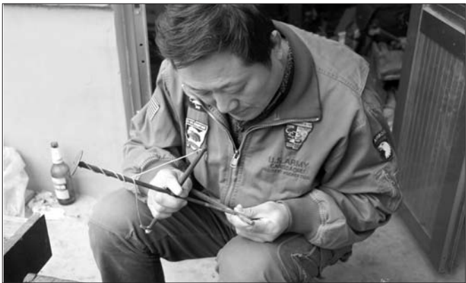
▲用舞钻在秤杆上钻铜丝粗细的秤星眼,要求非常精密。
