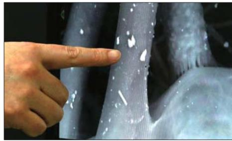
通过显微镜放大2000倍后,能清晰地看到附着在滤芯材料纤维上的雾霾颗粒。
