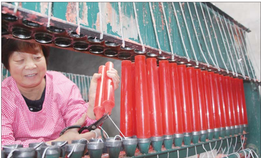
▲制作春节对蜡,一般需要化蜡、上色、定型、晾干、烫金五步。
