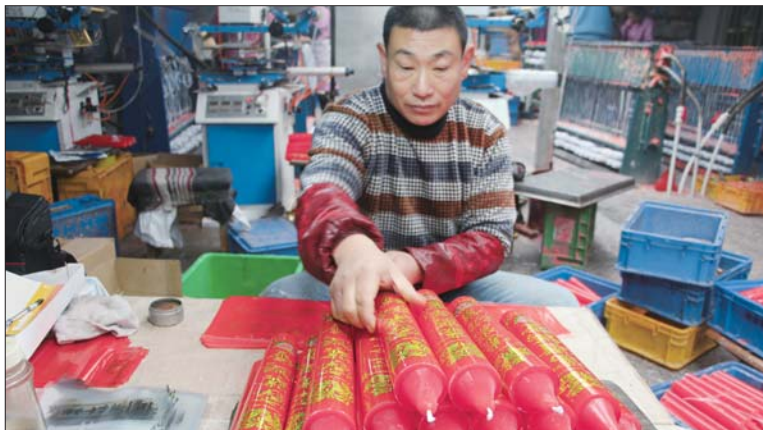
▲制作春节对蜡,一般需要化蜡、上色、定型、晾干、烫金五步。
