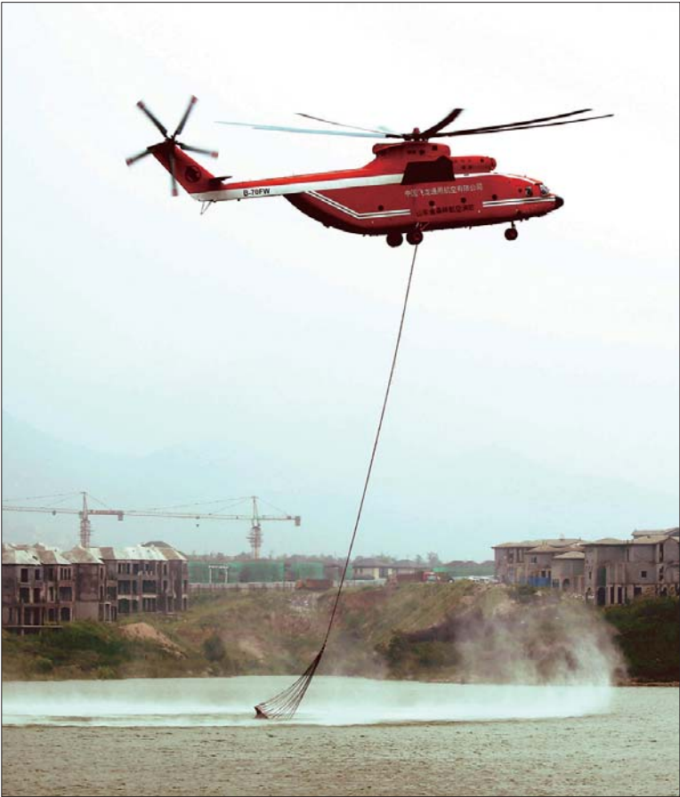
米26灭火直升机可以装载15吨水，是一般直升机的五到七倍。
