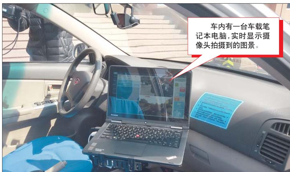
车内有一台车载笔记本电脑,实时显示摄像头拍摄到的图景。
