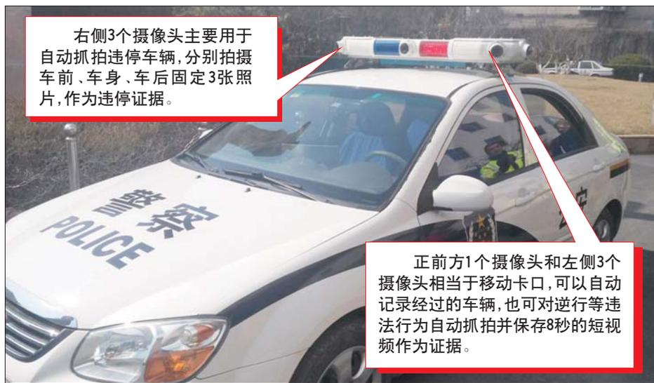
右侧3个摄像头主要用于自动抓拍违停车辆,分别拍摄车前、车身、车后固定3张照片,作为违停证据。
