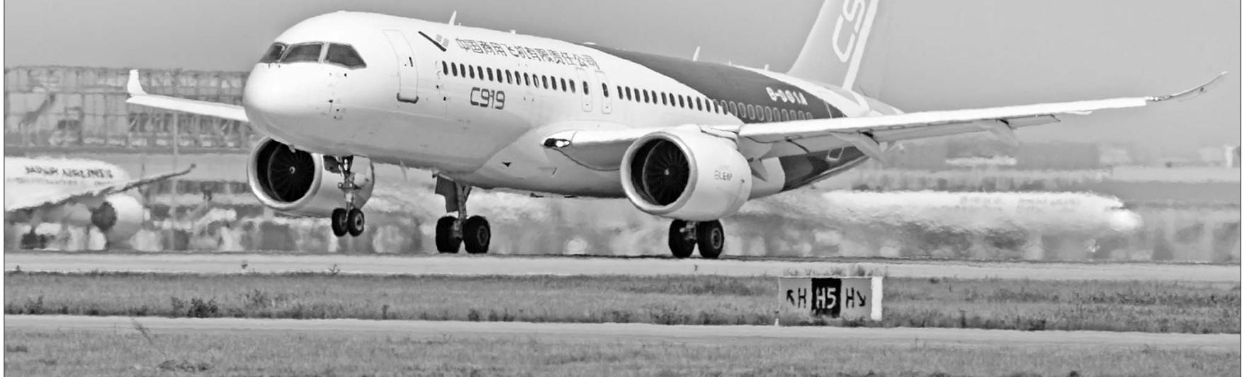
4月23日8时30分,国产大型客机C919在上海浦东机场进行高速滑行抬前轮试验,取得成功。这是C919进行的第四次高滑试验。
