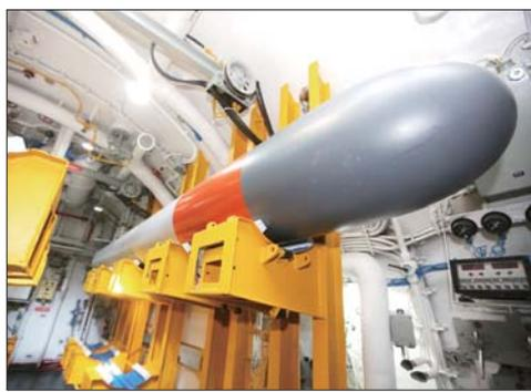
鱼雷舱是第一个舱室,两侧排列整齐的架子是鱼雷架,靠近艇艏的位置是鱼雷发射管,分为上下两排,共六枚。
