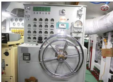
主机舱通过蒸汽轮机带动轴系,为航行提供动力。舱室有一大一小两个圆形舵轮,实现前进或后退。舵轮上方的指示表,可以看到运行状态及运行速度。
