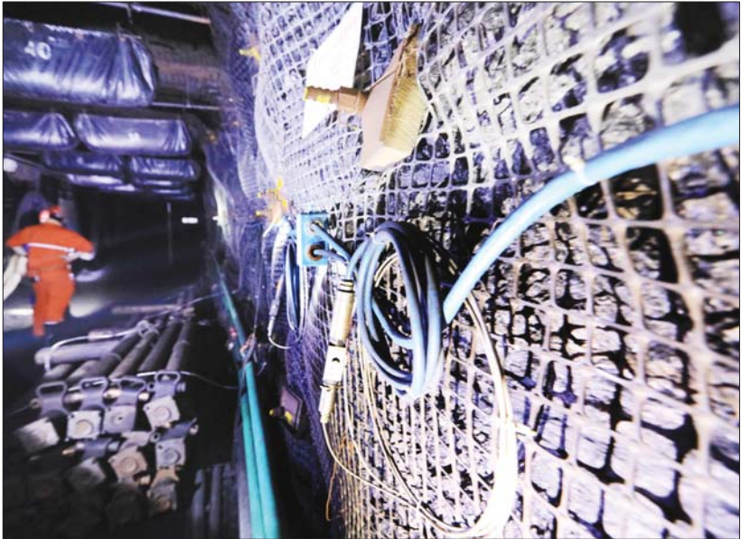
矿井下安装了深井地压微震监测系统，实时监测地压数据。
