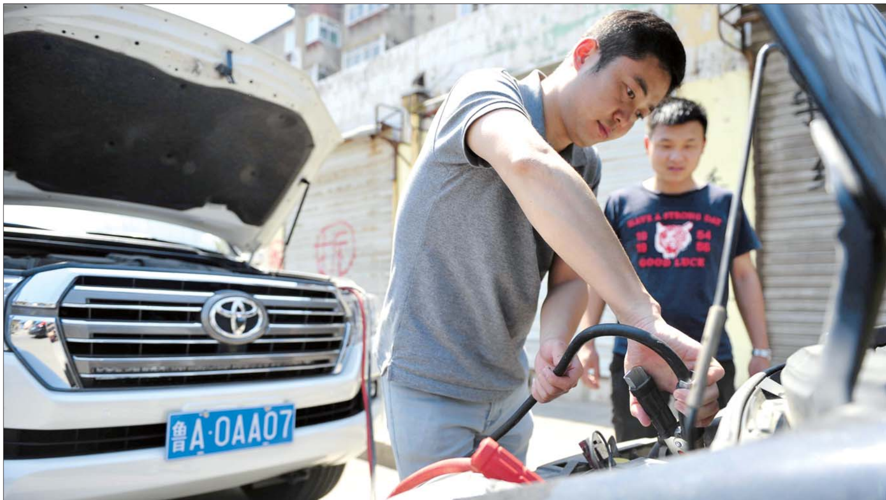
在路边,祝传新用电瓶连接线将自己的车和对方的车进行连接充电。
