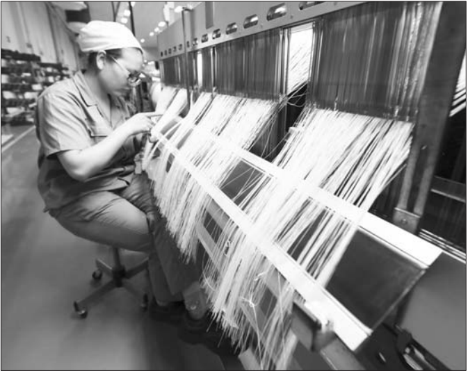
石头高温熔化后,再拉丝纺织成布。
