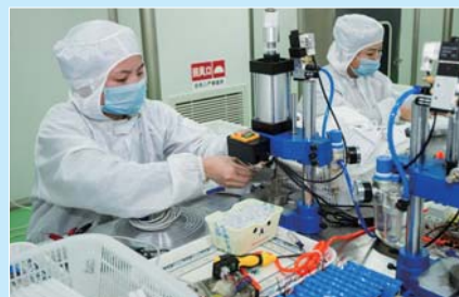
德州健洁医疗器械有限公司成功设计了加工工装“卡扣装配机”
